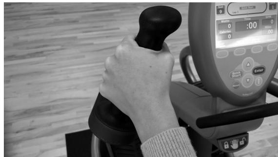
2. Pour verrouiller les bras et pédales, poussez sur le bouton StrideLock. Vérifiez que le verrouillage est enclenché en poussant ou en tirant sur la poignée du bras.
