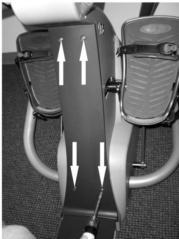
3. Retirez 2 vis sur la partie avant droite du couvercle de la garniture et retirez le couvercle de son cadre.
